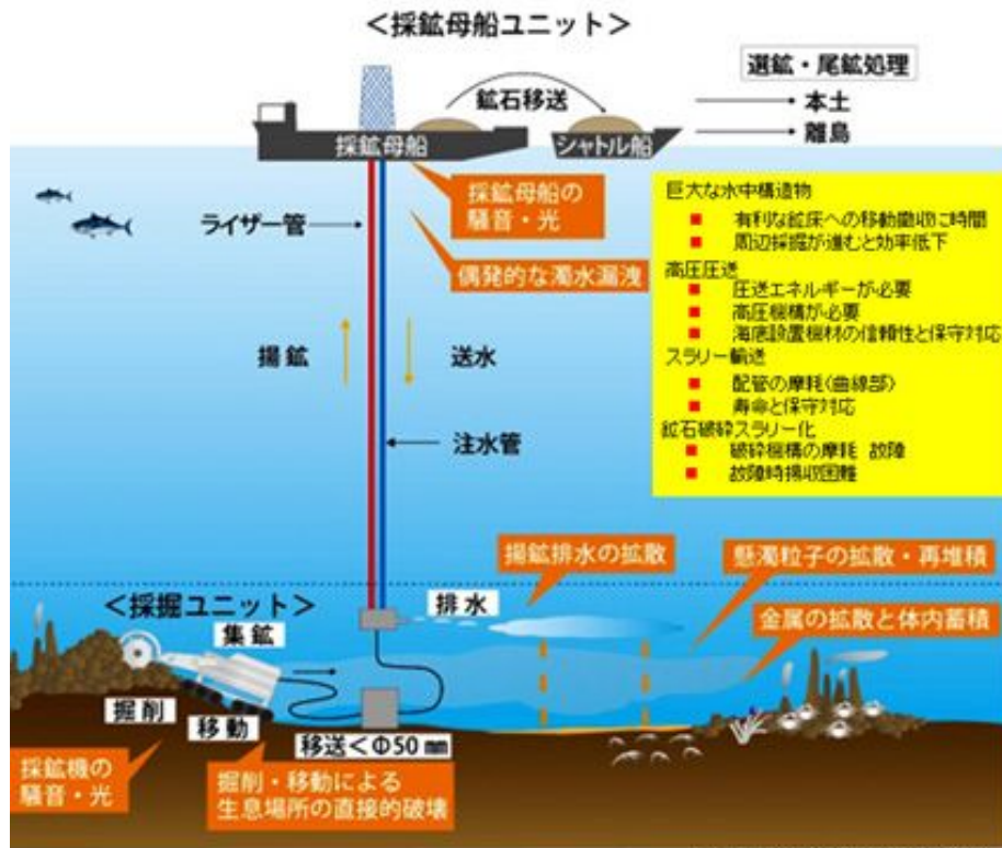
図2.2 熱鉱床揚収システム
